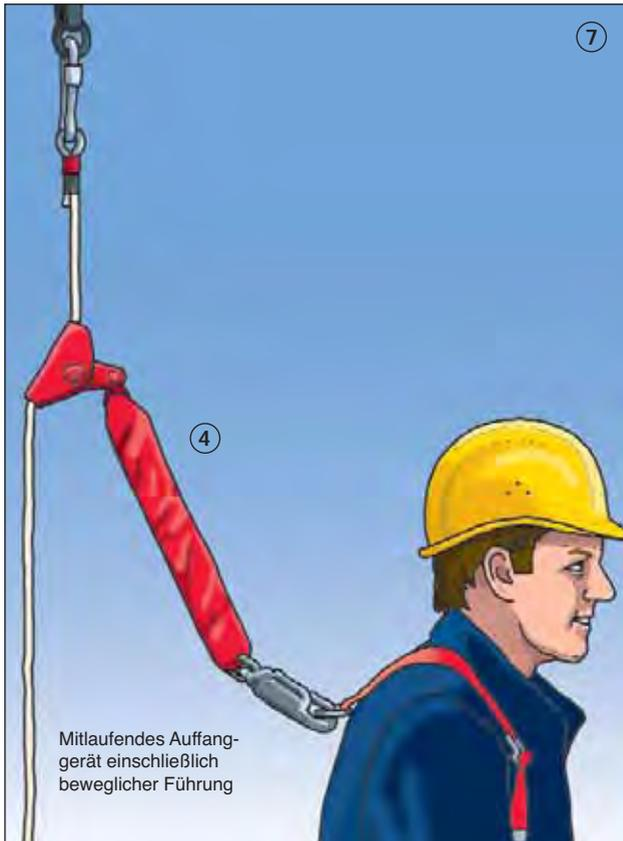
Mitlaufendes Auffanggerät einschließlich beweglicher Führung
