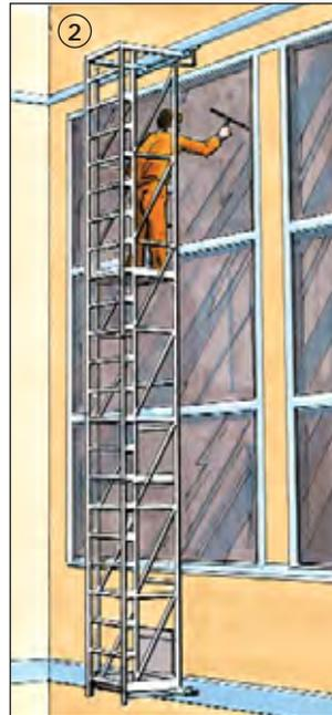
Fassadenbefahranlagen sind Einrichtungen, die zum Gebäude gehören und am Gebäude verbleiben, im Gegensatz zu Arbeitskörben, Arbeitssitzen und Arbeitsbühnen.
